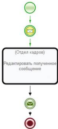
Рисунок 3.30. Состояние экземпляра бизнес-процесса
